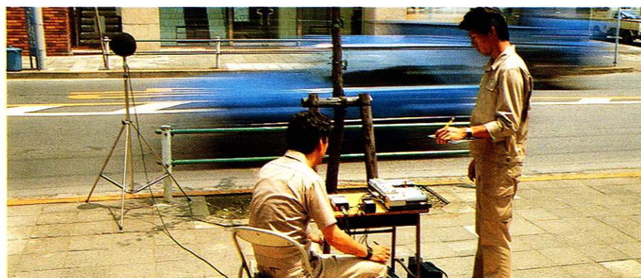
交通量の多い道路での騒音測定
